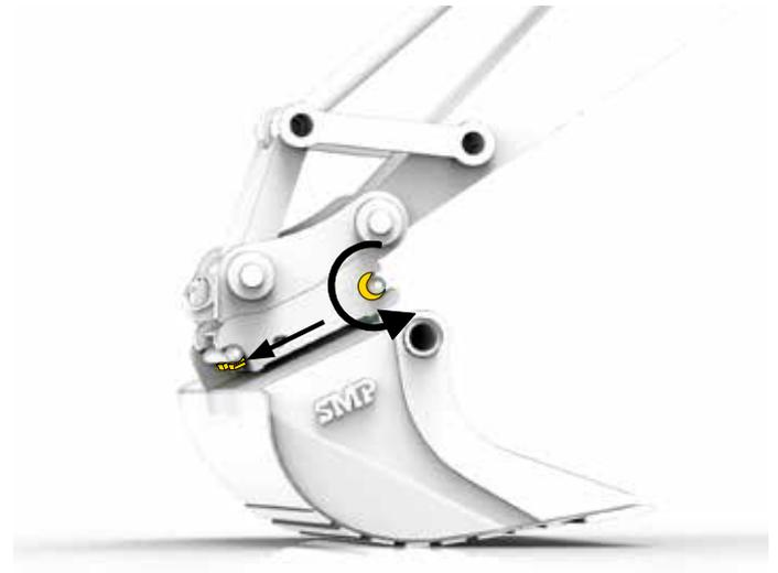
5. Kontrollieren Sie anhand der Anzeigen, dass der Schnellwechsler verriegelt wurde. Beide Anzeigen dürfen nicht sichtbar sein.
